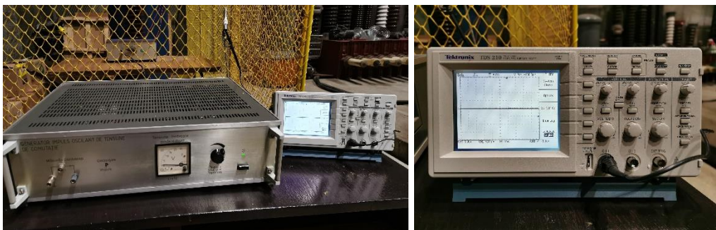
Fig. 7 – Conectarea osciloscopului digital pentru măsurarea impulsului de tensiune de comutație oscilant amortizat
